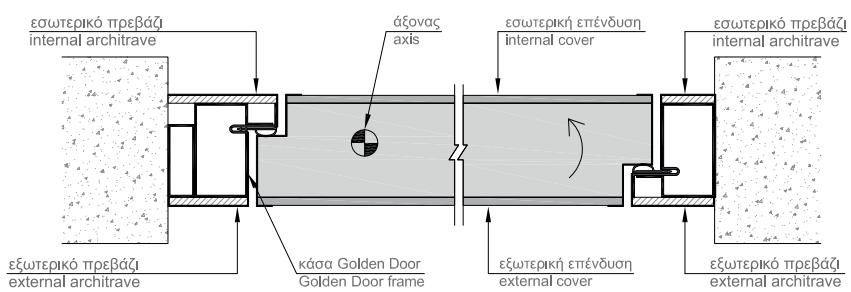
Τοποθέτηση αξονικής πρόσωπο μέσα με χωνευτή κάσα | Face in installation with hidden frame | تركيب الواجهة الداخلية ذات الإطار المخفية
