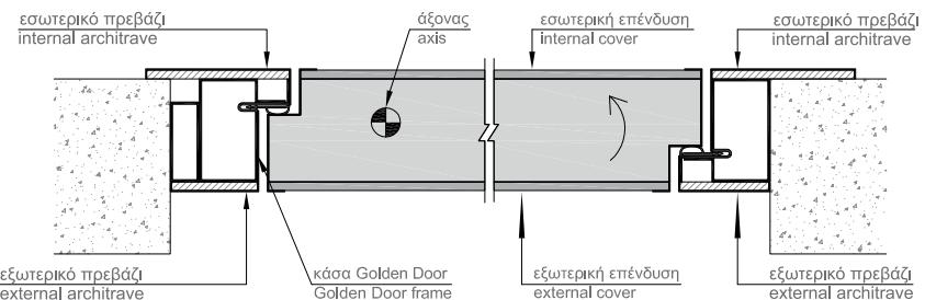
Τοποθέτηση αξονικής στη μέση του τοίχου | Pivot door tunnel installation | تركيبا لنفق
